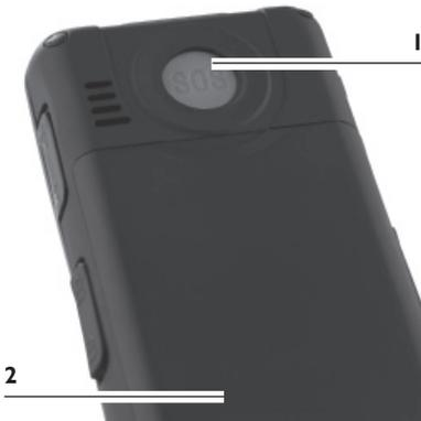
1. Notrufknopf: Bei Betätigung ertönt ein lautes Alarm-Signal und es werden nacheinander vier eingespeicherte Notrufnummern angewählt. Zusätzlich wird eine vorher eingespeicherte Notruf-SMS an die erste eingespeicherte Mobilfunknummer gesendet.
