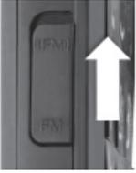
1. Schieben Sie den FM-Schalter auf der linken Seite des Telefons nach oben, um das Radio einzuschalten.
